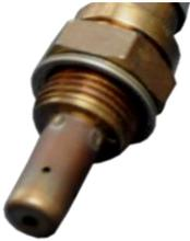
Die Lambdasonde hat vorne am Sondenkopf eine Bohrung, sowie an der Seite weitere 3 Löcher. Reinigen Sie die Sonde sehr „vorsichtig“ mit einem weichen Pinsel und Druckluft. Reinigen Sie auch das innere Einschraubgewinde (am Abgasrohr). Anschließend montieren Sie die Sonde mit einem Drehmoment von ca. 60 Nm.
