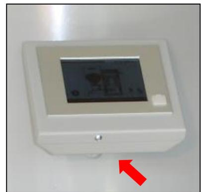
Das Touchpanel darf nur mit einem feuchten, weichen Tuch gereinigt werden. Zum befeuchten des Tuches Bildschirmreinigungsmittel, zum Beispiel einen antistatischen Schaumreiniger, Wasser mit Spülmittel oder Alkohol verwenden. Das Reinigungsmittel zuerst auf das Tuch und nicht direkt auf das Terminal sprühen. Damit soll vermieden werden, dass das Reinigungsmittel z.B. durch Lüftungsschlitze am Gehäuse des Terminals in die Elektronik laufen und dort Schäden verursachen kann!
