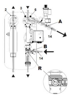
Verschließen Sie das Ventil "VRM3" (3) – blauen Handgriff (6) hierzu im Uhrzeigersinne drehen. Drehen Sie den roten Handgriff (5) um 45° im Uhrzeigersinn: dadurch wird es möglich, dass Rückschlagventil des Kugelhahnes (2) abzusperren. Verschließen Sie das Ventil R des Durchflussreglers (in horizontale Position bringen).
