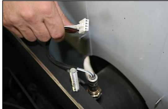
Abb. 31: Verbinden Sie als nächstes das Kabel für die Lambdasonde mit dem Gegenstecker des Verbindungskabels.
