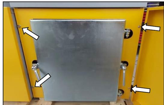
Abb. 17: Demontieren Sie nun die Rahmenblende, indem Sie auf der rechten Seite die beiden Inbusschrauben und auf der linken Seite die beiden Magnete entfernen.
