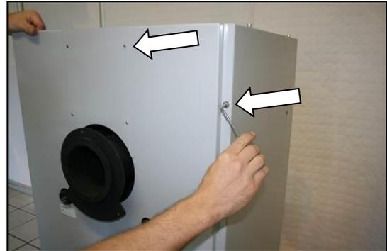
Abb. 16: Entfernen Sie die rückseitige Verkleidung. Dazu das kleine Abdeckblech entfernen. Danach die 8 Inbusschrauben entfernen. Nachdem alle Schrauben gelöst wurden, können Sie das Verkleidungsteil abnehmen.
