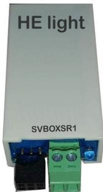
Abb. 43: HE light "PWM Controller für die hocheffiziente Solarpumpe"
