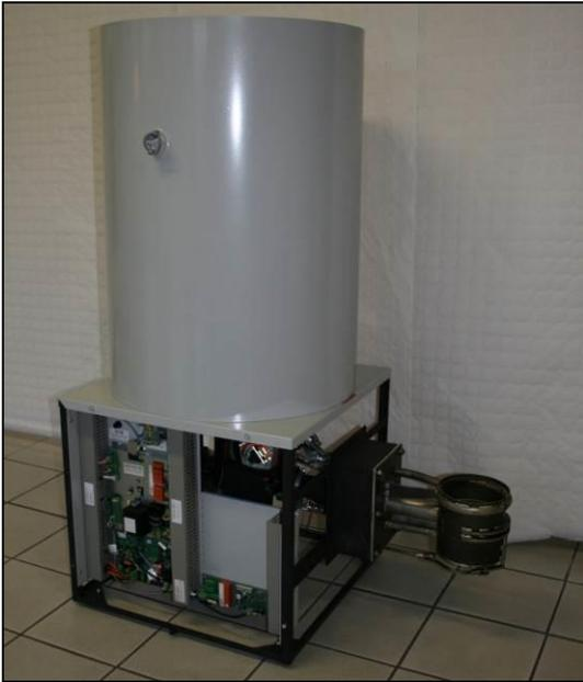
Abb. 13: Fördereinheit mit angeflanschem Brenner
