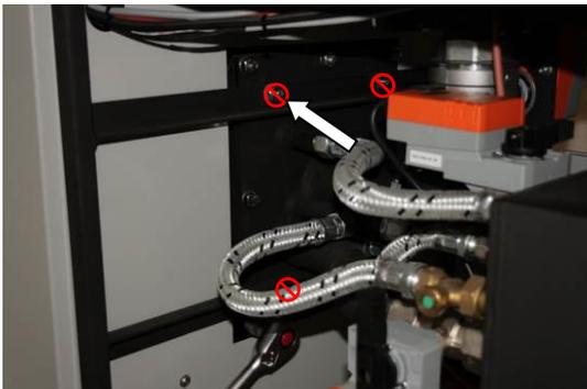
Abb. 10: Diese 4 Muttern, welche sich auf den beiden Querstreben befinden, dürfen nicht zur Demontage gelöst werden!
