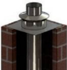
Abb. 15: Montiere die Kopfabdeckung und den Wetterkragen wie dargestellt auf dem Schornsteinkopf.
