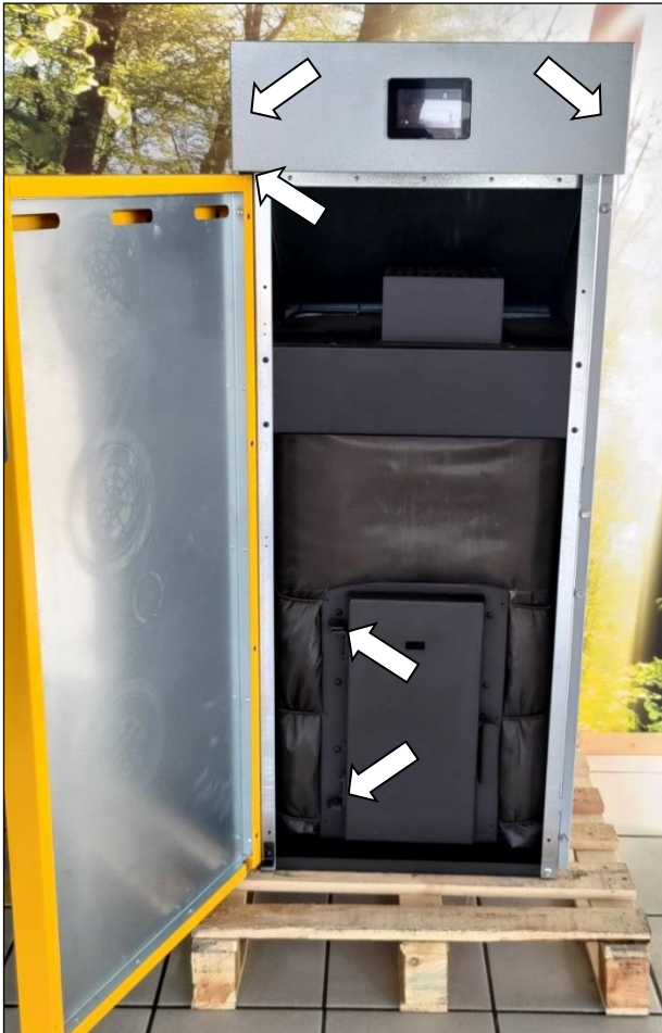
Abb. 4: Dieses Bild zeigt die Kesselftont und die Stellen, an welchen Teile zur Einbringung demontiert werden können.
