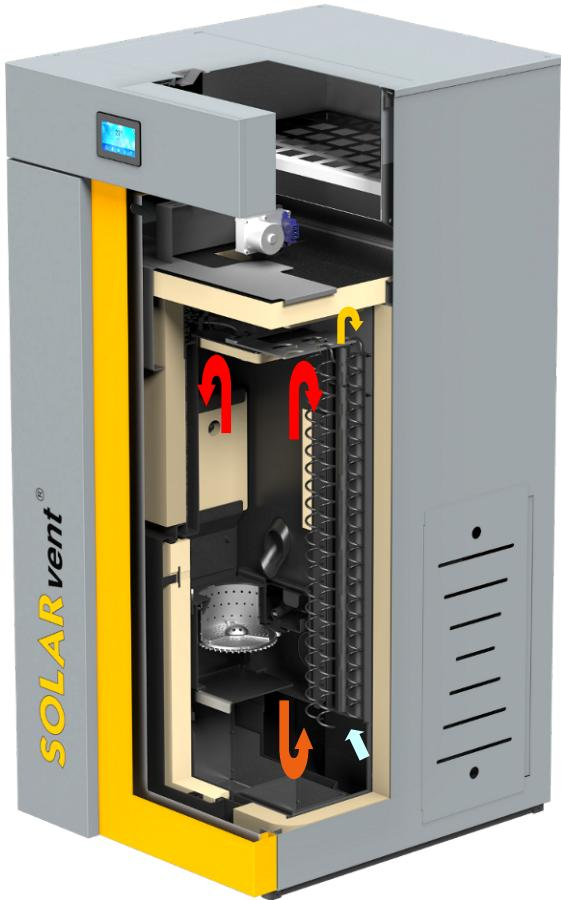
Die Abgasführung ist wie folgt aufgebaut: Der Brenner flammt senkrecht nach oben in Richtung des inneren Brennraumdeckels. Die heißen Abgase werden anschließend rechts und links hinter den beiden Schamottplatten nach unten umgelenkt und übertragen dort erstmals ihre Wärme über die Wärmetauscherflächen an den wasserführenden Kesselkörper.
